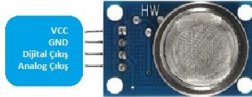
Resim 11.21: MQ-2 Gaz Sensörü Pin Bağlantıları
