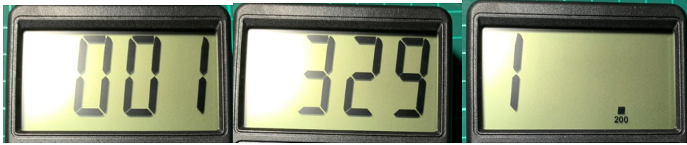
Resim 3.7: Avometre Direnç Ölçümü
