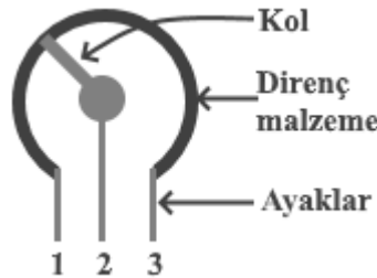
Resim 2.14: Potansiyometre Ayak Yapısı
