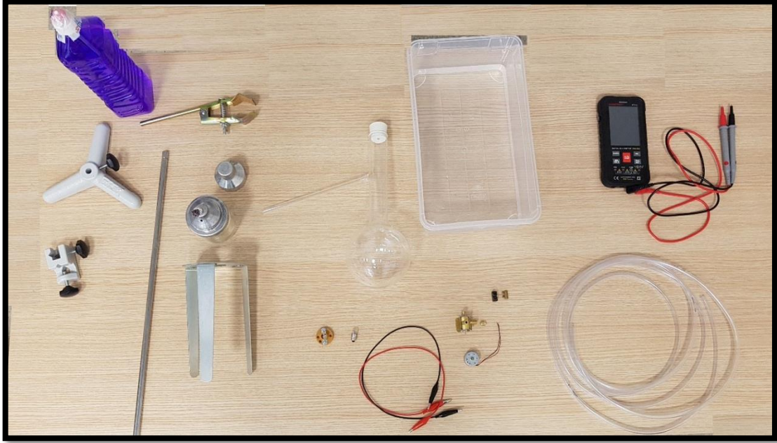
Şekil 4-4 Isı enerjisinden elektrik enerjisi elde etme deney elemanları
