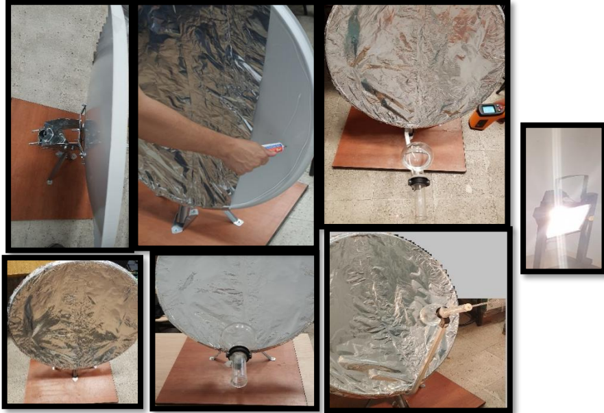
Şekil 6-5 Ayna odaklama ile güneş enerjisinden ısı enerjisi elde etme deneyi
