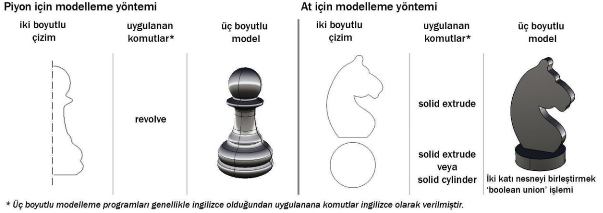
Şekil 2.9. Satranç takımındaki piyon ve at elemanlarını üç boyutlu modelleme yöntemleri
